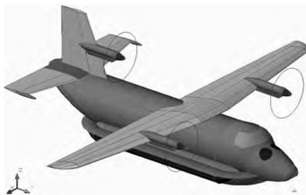
Самолет с шасси на воздушной подушке проекта «20»
